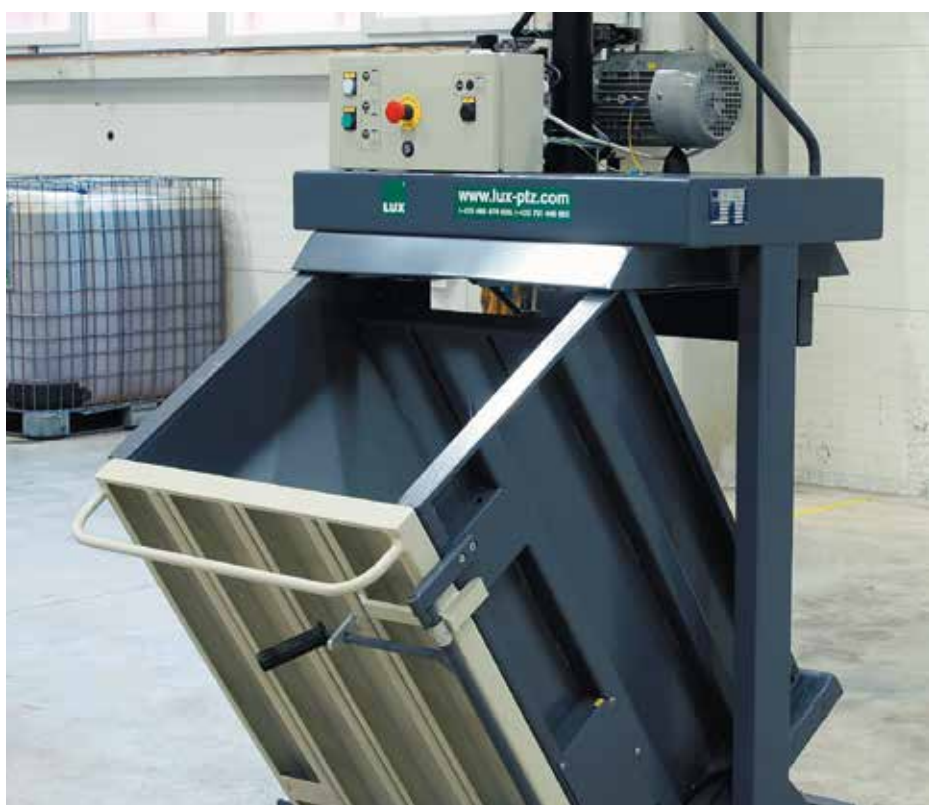
Vyklopená komora připravená pro plnění materiálem
