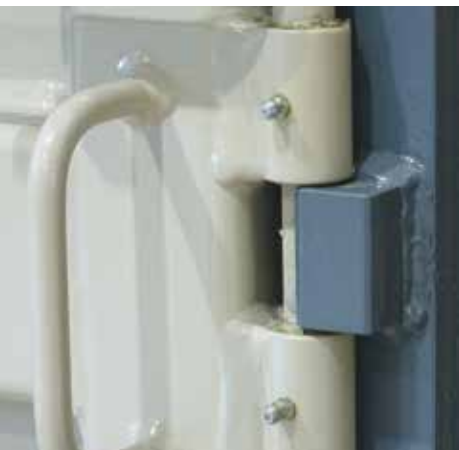
Maznice na pohyblivých částech u všech lisů dokazují správné strojírenské provedení
