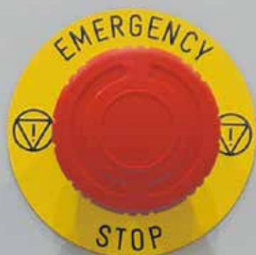
„TOTAL STOP“ Nejdůležitější bezpečnostní prvek s dvojitým zapojením
