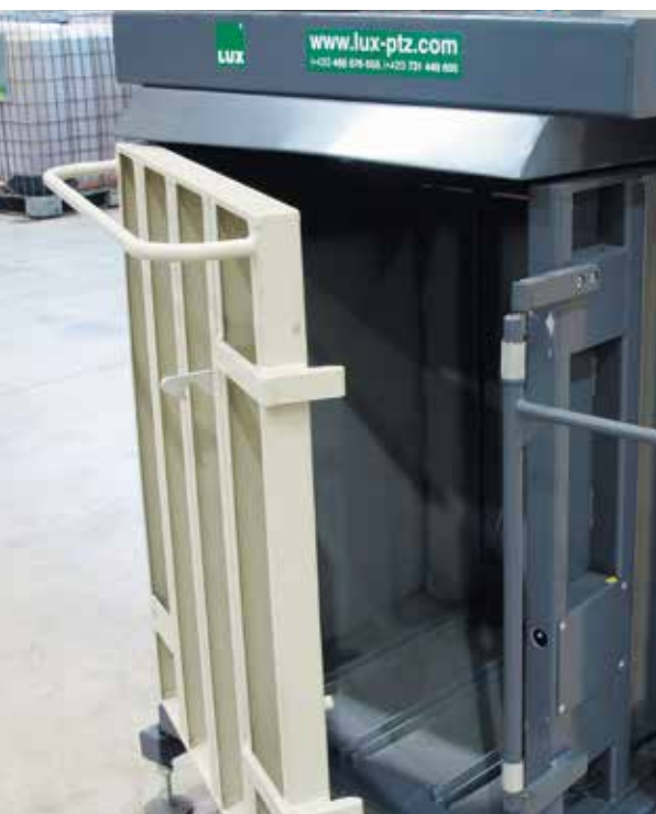
Pohyblivá boční stěna komory pro snadné vyjmutí balíku s koncovým spínačem pro hlídání správného uzavření dveří
