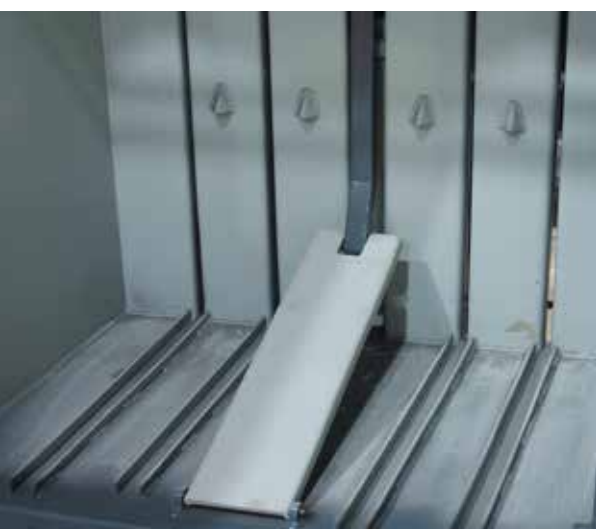
Těžké slisované balíky jsou z lisu vykloupeny vyklápecí klapkou
