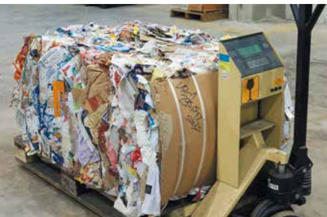
Hmotnost slisovaného balíku běžného směsného papíru je až 290 kg
