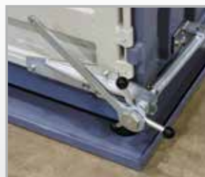
Bezpečnostní zajištění dveří při lisování expanzivních materiálů
