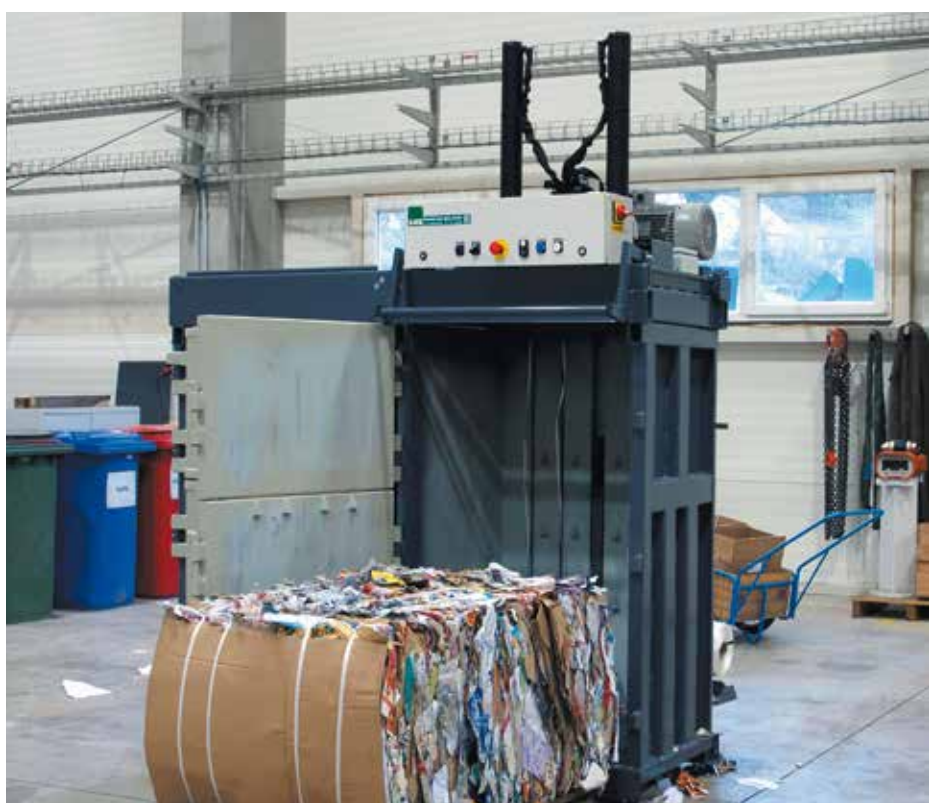
Slisovaný balík vykloupený před lis na připravenou paletu
