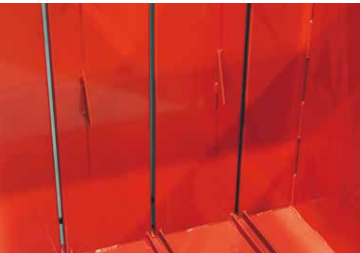
Standardem u všech lisů jsou zpětné klapky sloužící k zachycení zpětné expanze lisovaného materiálu v lisovací komoře
