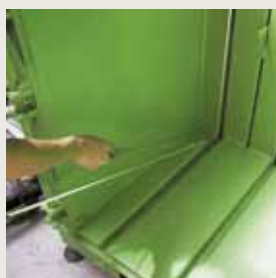
Заправка вяжущей полосы перед прессованием.
