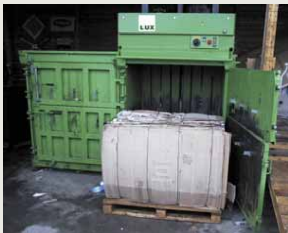
Двухкамерный пресс L30-2 – пример выгрузки пакета на поддон – картонаж 390 кг.
