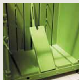
Гидравлическая выгрузка спрессованного пакета.
