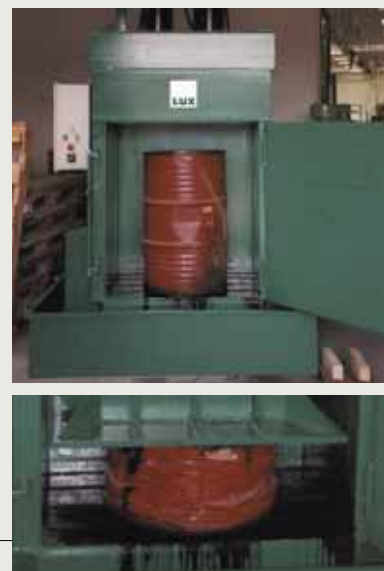
Можем удовлетворить специальные требования наших заказчиков. На фото справа Стоitonный пресс L100 для бочек заполненных масляными фильтрами. В конструкции пресса предусмотрена ванна для масла.
