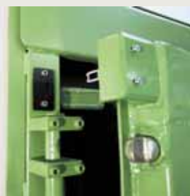
Кодовый замок безопасности по EN 60-947-5-1.
