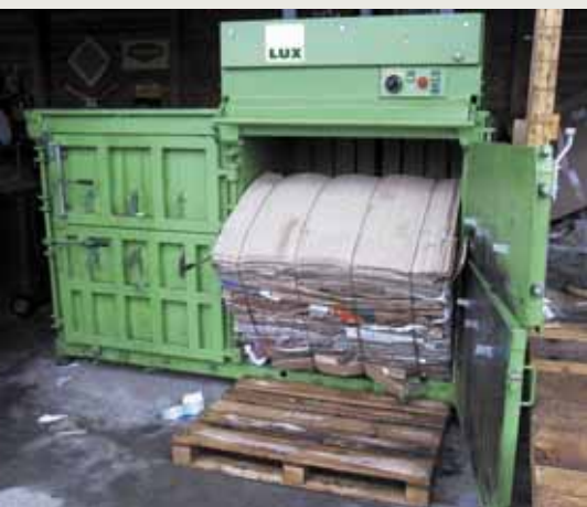
Двухкамерный пресс L30-2 – пример выгрузки пакета на поддон – картонаж 390 кг.
