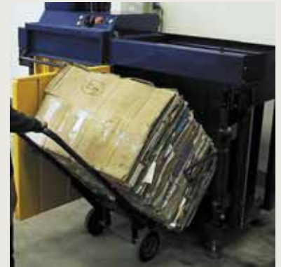
Выемка готового пакета из пресса с помощью манипуляционной тележки.
