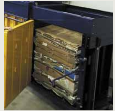
Спрессованный и связанный пакет картонажа в прессе – вес пакета 85кг.
