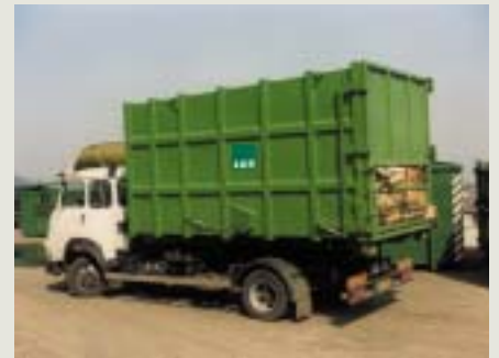
Přípojný kontejner PK 20 naložený i na menším svozovém vozidle
