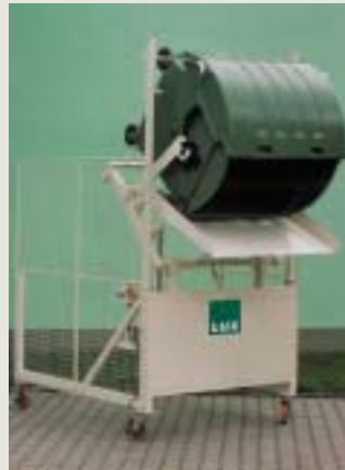
Snadné vysypání kontejneru se slisovanou kartonáží
