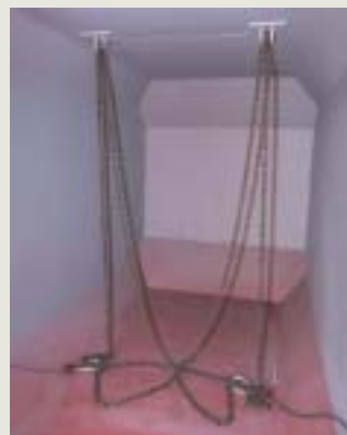
Vnitřek kontejneru. Nahoře: lisovací deska a zpětné klapky, vlevo: vyprazdňovací zařízení
