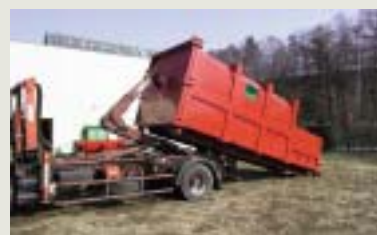
Natahování lisovacího kontejneru na svozové vozidlo
